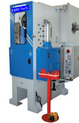
Druckkissengesteuerter-Lamellenstanzausautomat 1-2 Spuren bis 270 spm
